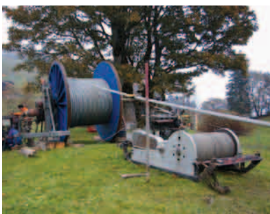
Provisorische Seilwinde übers Tal
